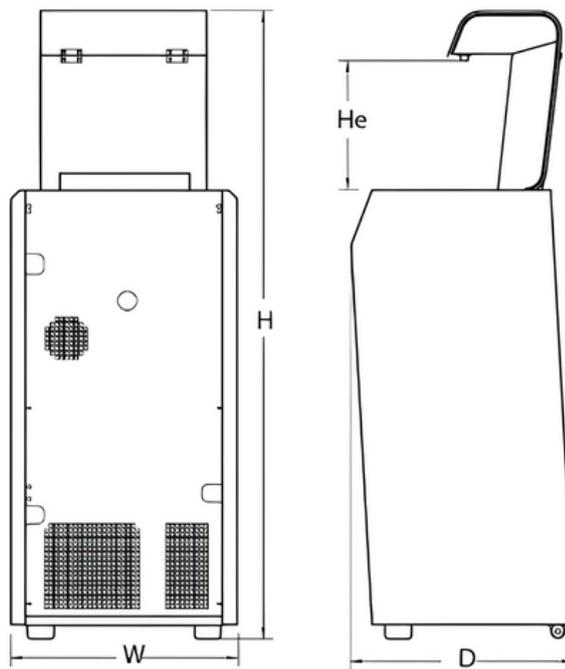
Erogatore d'acqua da **150 l/h** con opzioni fredda, gassata e ambiente, dotato di doppia serpentina e pompa di carbonazione. Design sofisticato in **acciaio, alluminio e controllo touch screen**. Efficiente, ecologico con **personalizzazione erogazione**.
